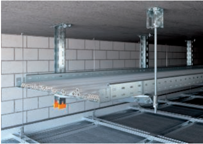
Einlagige Deckenabhängung mit Hängestiel und Ausleger.
