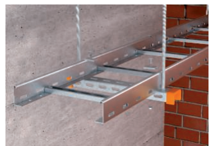
Montage auf Querprofil mit Klemmstück, Flachrundschauben und großen Unterlegscheiben.
